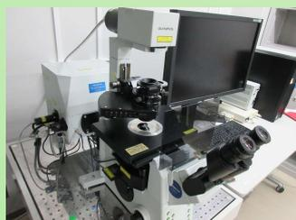
共焦点レーザー走査型顕微鏡
