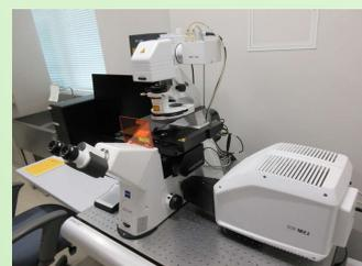
共焦点レーザー走査型顕微鏡
